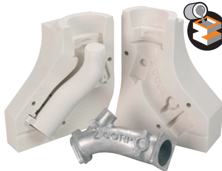
Modell: Rohrstutzen, Z™Cast Form mit Gußteil Information: Umsetzung Aluminium- Gußteil: 48 Stunden
